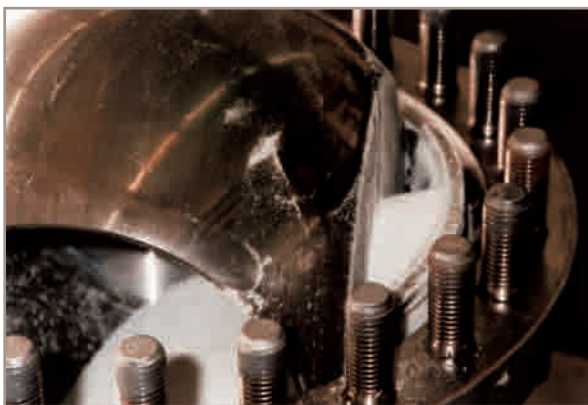
Bild 7 Kugelhahn, DN 250 Schaltwelle und Lager nach einem Jahr im Polymer-Einsatz
