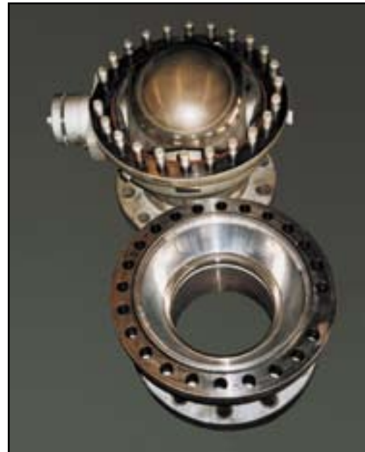
Bild 1 Argus Kugelhahn mit metallischem Dichtsystem nach 70.000 Schaltungen
