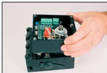
Aufsetzen der F5 auf den P5/ EP5, Anziehen der Schrauben
